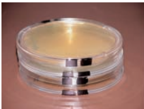
Figura 6 - Marcatura delle piastre per il campionamento di superfici
